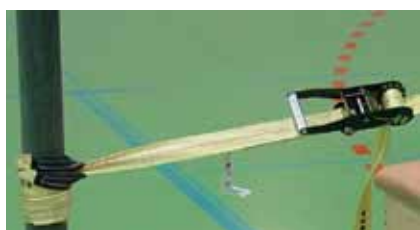
Abb. 4: Mehrmaliges Umwickeln der Befestigungsschleufen um die Säulen vermindert den „Streckenverlust“ der Slackline
