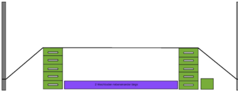
Abb. 13: Aufbau einer Highline. Der Fixpunkt sollte weiterhin möglichst tief an der Säule angeschlagen werden
